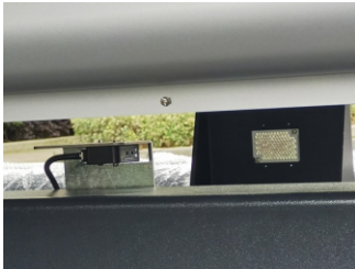
采用对射式光电开关材料检测系统，适合各种材料打印
